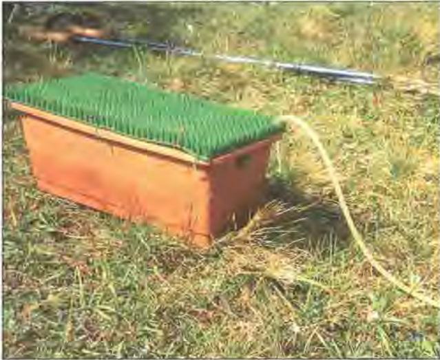
Foto 6: Selbstkonstruierter Staubfangkasten. Das Bild zeigt den Status während der Wartung. Auf der Schmalseite ist der erhabene Überlauf zu sehen (rund, im Schatten). Ein Silikon-schlauch führt die Suspension in Probenflaschen über (31.05.02, Zugspitzplatt 2200 m).
