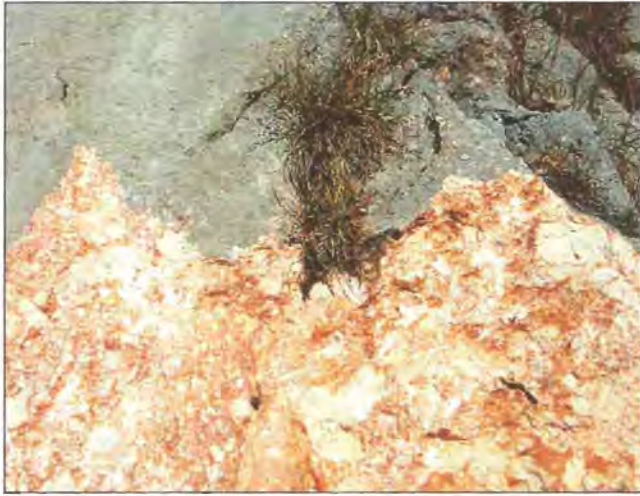
Foto 4: Tektonische Brekzie (Dachsteinkalk) im Anschlag. Die Haarrisse sind mit eisenoxidhaltiger Matrix verheilt (Schreck-sattel 1670 m, 25.08.02).
